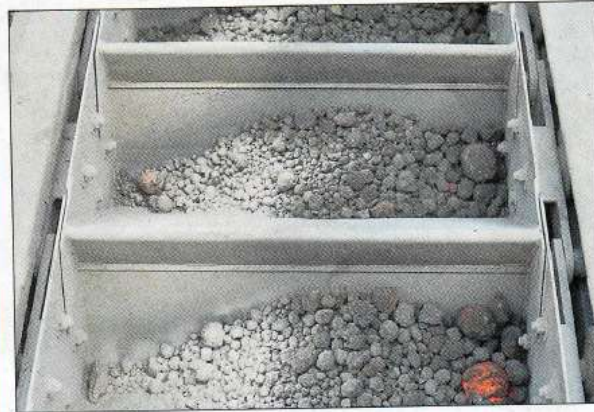
Der Schotter wird in einer Kugelmühle mit Ofenabgas getrocknet und zu Rohmehl gemahlen, das auf bis zu 1450 Grad erhitzt und in den hier auf dem Bild abgebildeten Zementklinker umgewandelt wird.
