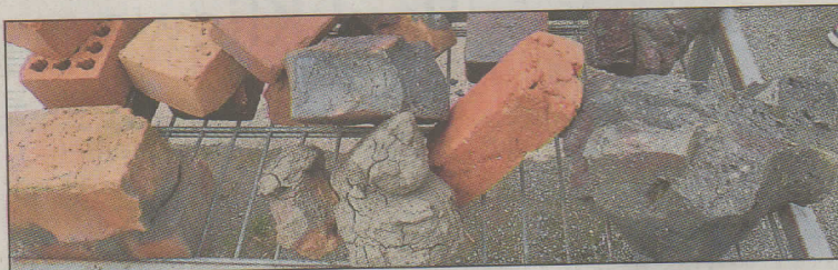
Fehlbrandsteine, die entweder zu wenig oder zu viel Hitze abbekommen hatten, sahen so aus.
