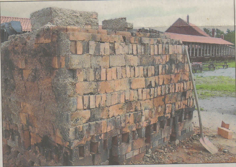
Das Bild zeigt einen einfachen Feldbrandofen der Museumsziegelei Lage bei Detmold. Die Ziegel wurden im Juli 2015 zu Demonstrationszwecken gebrannt.
